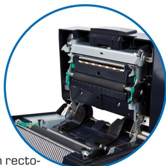
Impression recto-verso grâce à la technologie 2ST avec deux têtes d'impression thermique.
